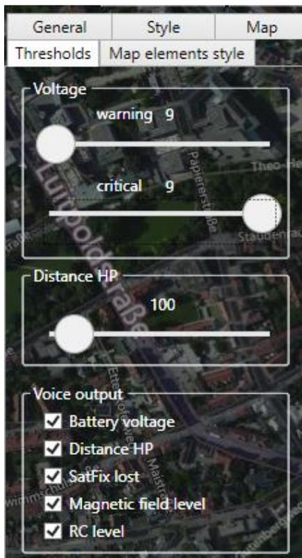
Hier lassen sich Grenzwerte für verschiedene Telemetriedaten einstellen. Im Moment sind Warnschwellen für die LiPo Spannung und die Distanz zur Home Position einstellbar.
