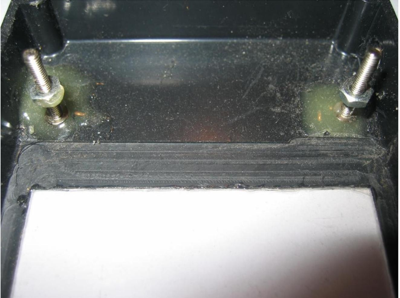
Hier kann man auch eine Alternative Befestigung für die Leiterplatte erkennen, wenn man das so macht befinden sich die Gehäuseschrauben auf der Rückseite und die Frontansicht ist ohne Schrauben.
